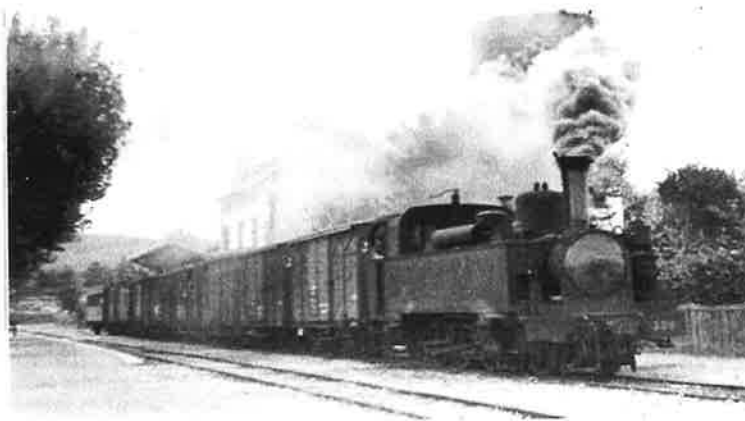
A l'automne 1950, le train mixte Buis-les-Baronnies - Orange marque l'arrêt au pied du château d'eau de la gare de Vaison. La locomotive 3994 est une des deux 130T livrées par Decauville en 1920 (série 3993/3994) à titre complémentaire. Traditionnellement, l'unique voiture à bogies est située en tête à la montée et en queue à la descente. Photo P.LAURENT - Collection Bernard ROZÉ
